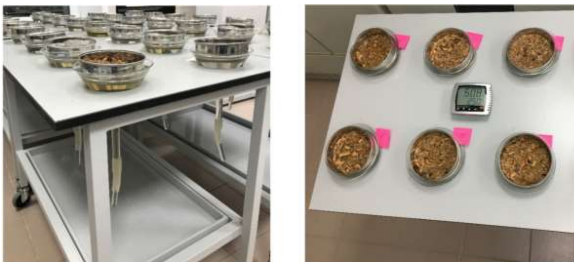
Рисунок 13 — Выделение нематод из древесины методом Бермана (ориг.)
