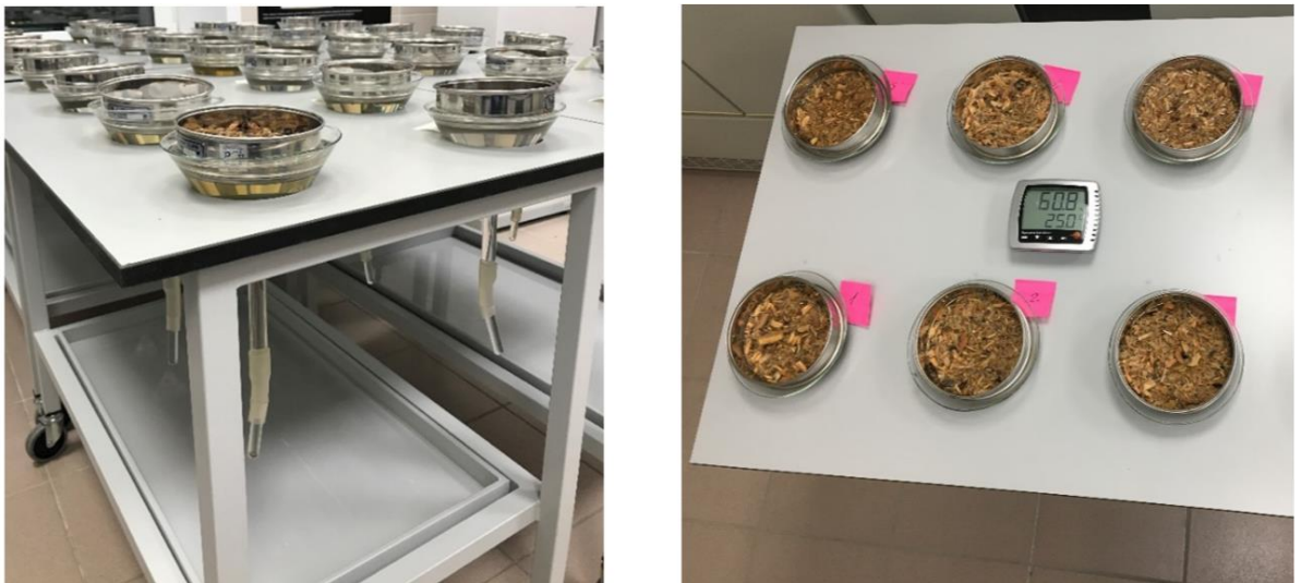
Рисунок 13 — Выделение нематод из древесины методом Бермана (ориг.)
