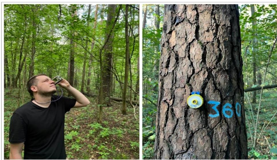
Рисунок 10. Измерение высот на пробной площадке с использованием Haglof Vertex III
