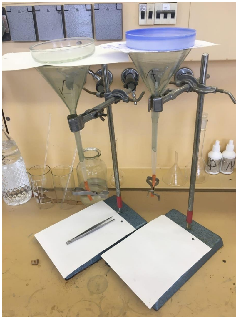
Рисунок 1. Установка для распределения реактивом в центрифужные пробирки.
