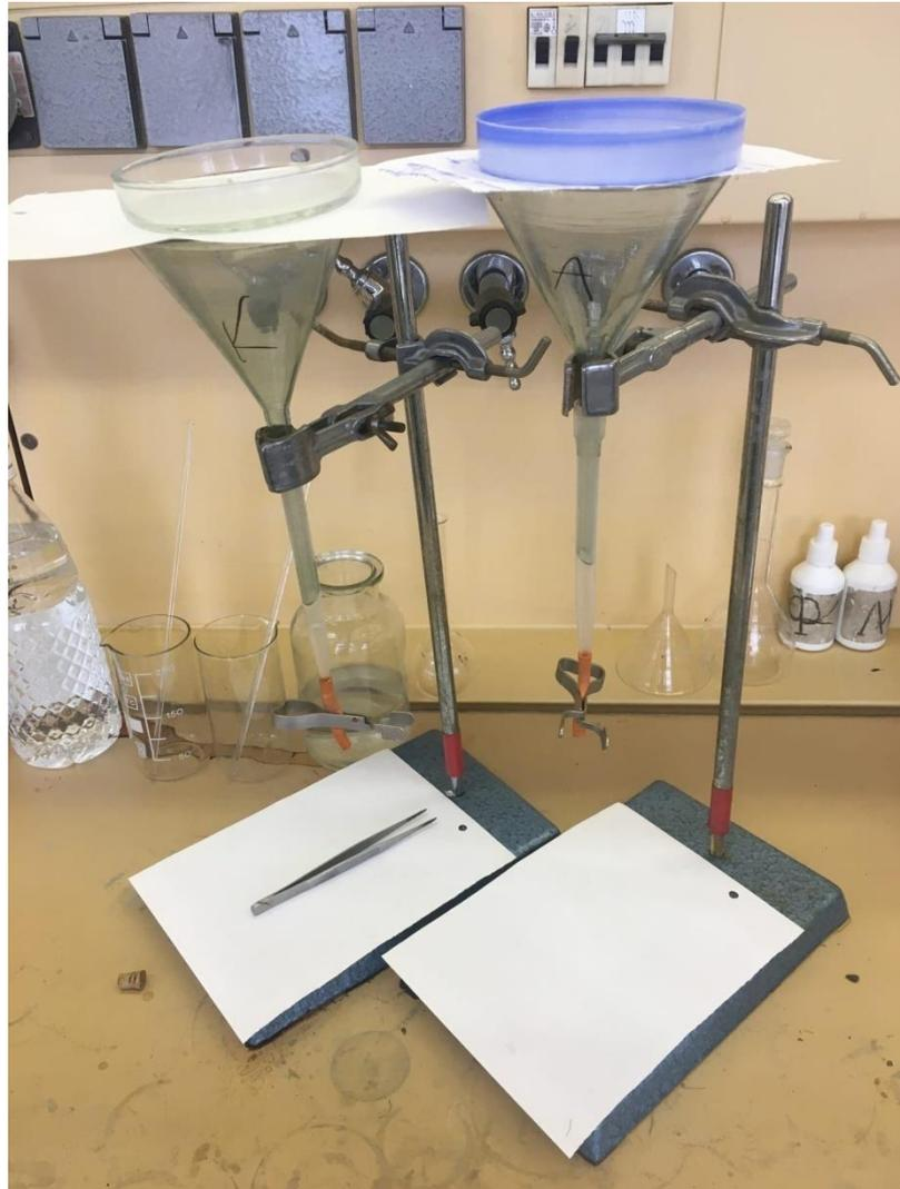
Рисунок 1. Установка для распределения реактивов в центрифужные пробирки.
