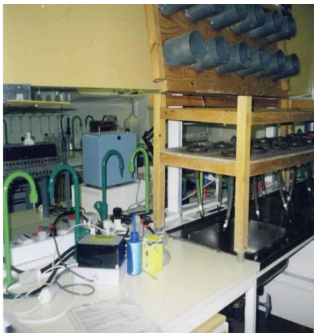
Рис. 3. Программируемый эклектор, использующийся для экстракции энхитреид методом О'Коннора в Шведском университете сельскохозяйственных наук (г. Уппсала). Фото: И. Горшкова.
