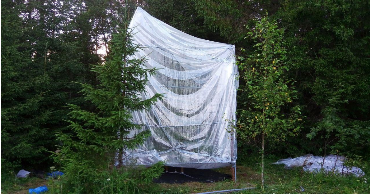
Рисунок 2.2. Экспериментальная камера, построенная вокруг ели для внесения ^{13}\text{C}\text{-CO}_2 . Высота камеры 5.5 м.
