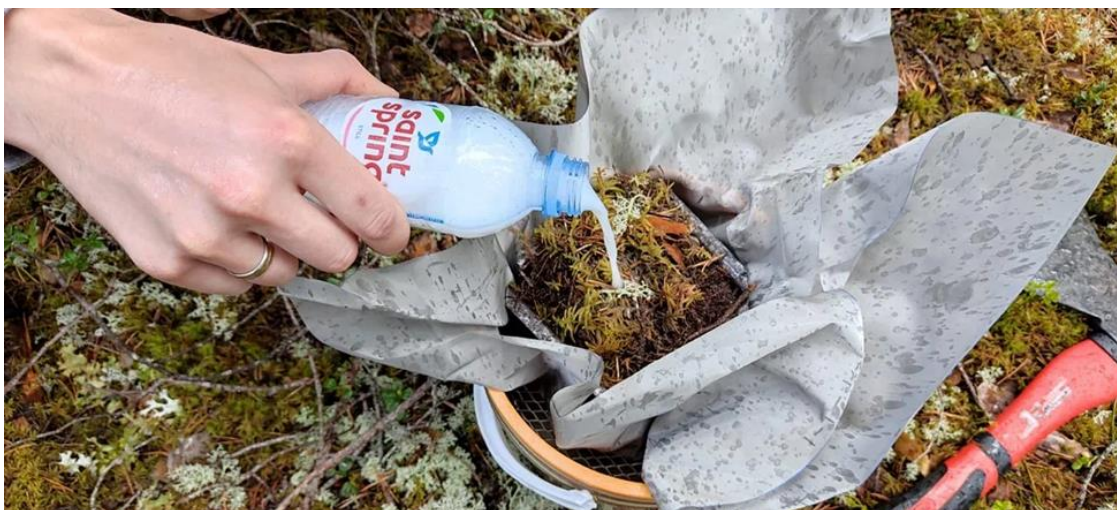
Рисунок 2.3. Процесс химического дефаунирования почвенных монолитов в полевых условиях.
