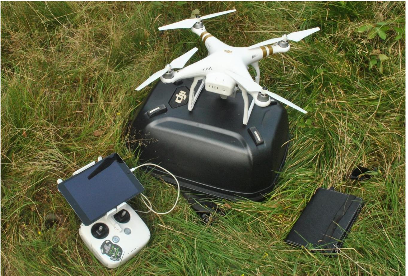
Рисунок 4П – Квадрокоптер DJI Phantom 3 Pro, пульт управления и планшет.
