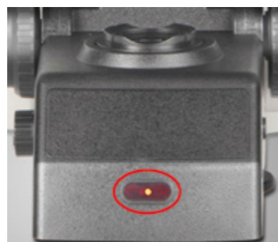
Датчик присутствия оператора. В отсутствие пользователя микроскоп автоматически выключается через 30 минут.
