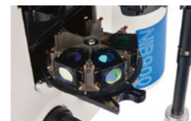
Турель флуоресцентных фильтров с шестью позициями обеспечивает удобную работу в нескольких каналах флуоресценции.
