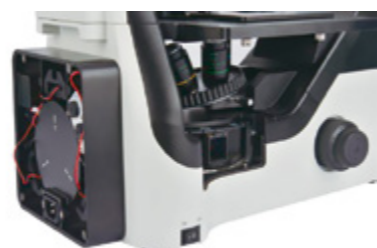
Светодиодный флуоресцентный осветитель, модель NIB620-FL. Длины волн (нм): 365, 405, 485, 525
