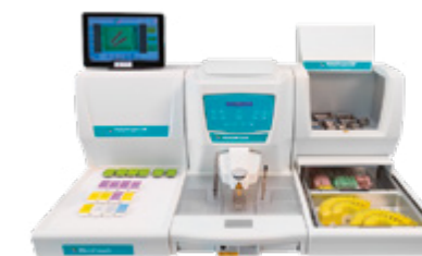
Milestone HistoDream EW — трехмодульная система для заливки тканей парафином.
