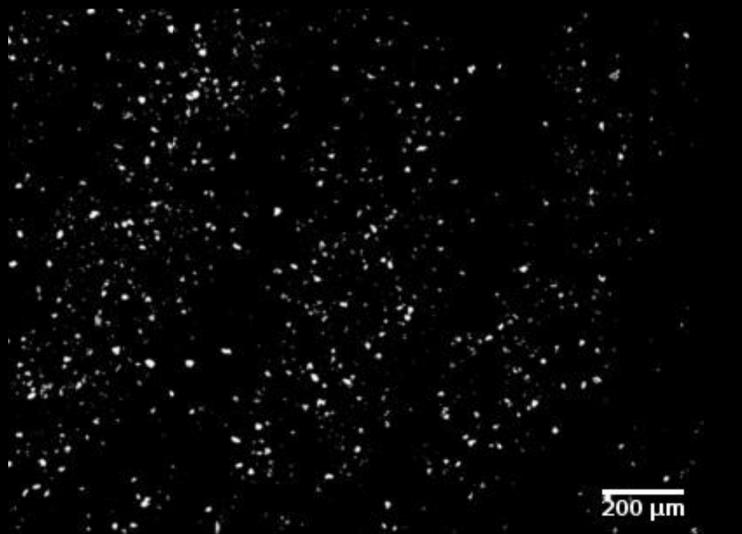
Число пылевых частиц на поверхности ламелл уменьшается после каждого контактного цикла
