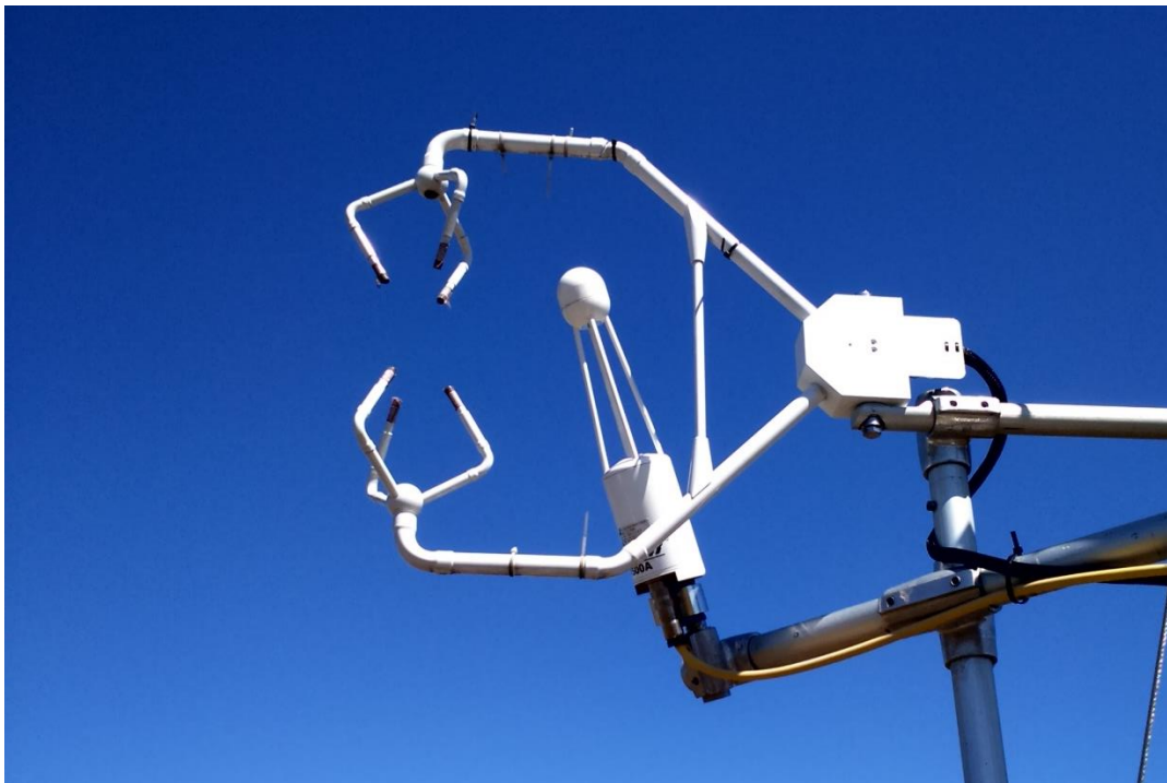
Рисунок 20. Пример установки оборудования для пульсационных наблюдений. (1) С-образный акустический анемометр CSAT-3 (Campbell Sci. Inc., США). (2) ИК газоанализатор \text{H}_2\text{O} и \text{CO}_2 открытого типа LI-7500A (LI-COR Inc., США).
