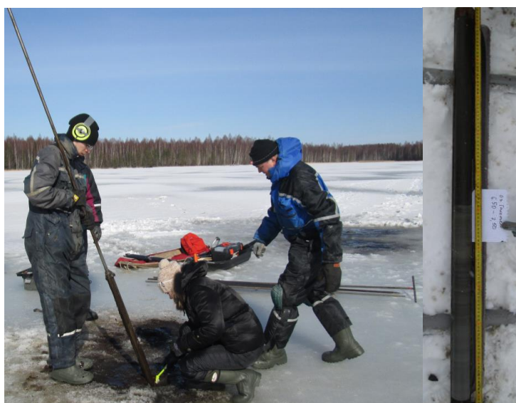
Рис. 3. Процесс отбора колонки донных отложений оз. Гахкозеро и отобранная колонка (6.50–7.00 м).
